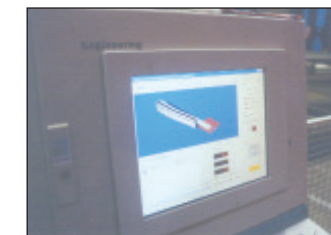
Mit der data M Technologie können im Rollformprozess problemlos 36 Achsen angesteuert werden
